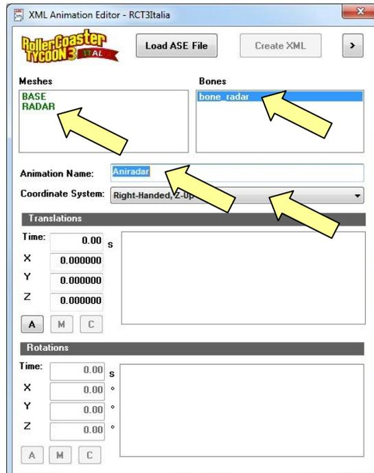
Nella sezione 'Translation' dovranno essere inserite le posizioni, nel tempo, del Pivot Point. Se ad esempio l'animazione prevede che l'oggetto a cui è legato salga di 6 metri in 5 secondi e in 10 secondi torni al punto iniziale dovrete inserire i valori indicati nella figura qui sotto :
